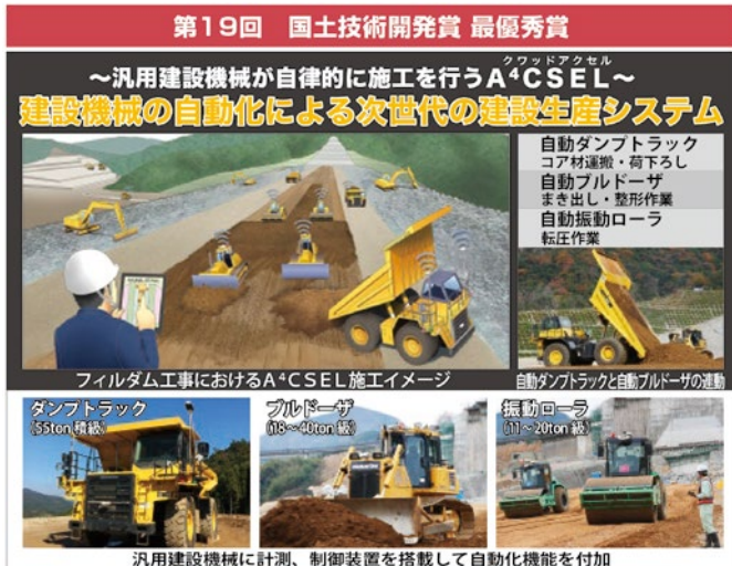
図-1 建設機械の自動化による次世代の建設生産システム 概念図
