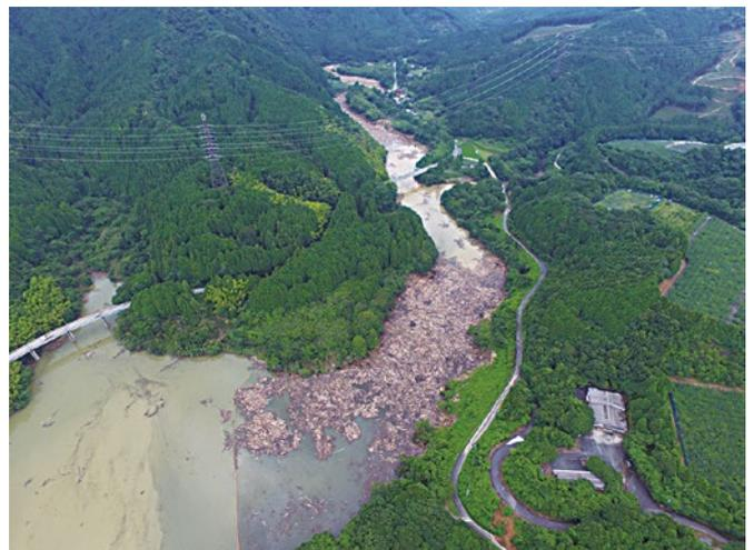
図-5 寺内ダム流木貯留写真(水資源機構提供)(約2万m<sup>3</sup>の流木が流れ込んだ)
