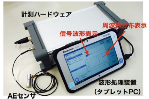
図-3 AEセンサーを用いた現場打音装置
