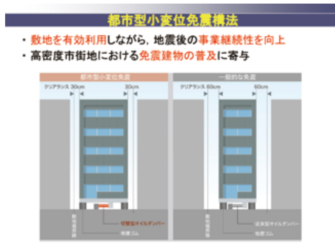
図3 パッシブ切替型オイルダンパーの開発と適用 概念図
