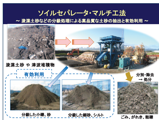
写真-5 ソイルセパレータ・マルチ工法概念図
