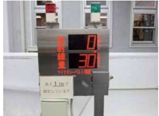
写真 4-3 放射線量のモニタリング盤（市庁舎前）
