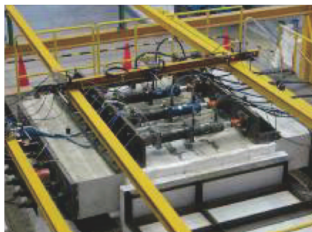
写真-3 耐火試験状況（曲げモーメント+軸力導入） （写真提供：大林組）
