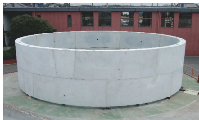
写真-2 SFRC セグメント 横浜環状北線シールド工事 （写真提供：大林組）
