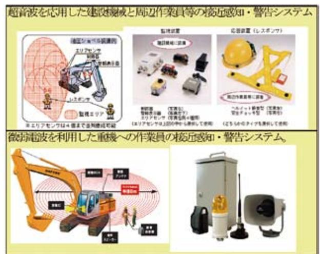
図-2 作業員接近感知・警報システム
