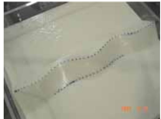
図-7 蛇玉現象の再現実験
