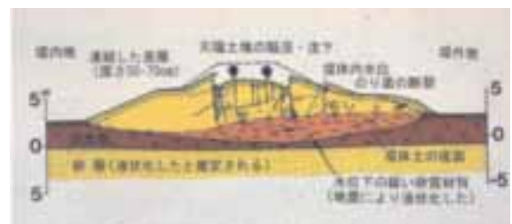
図-10 釧路沖地震による堤防の変形メカニズム
