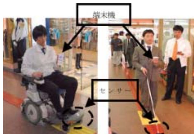
写真-5 車いす先端部のセンサーで読み取る
