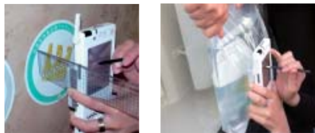
写真-7 タグの情報を読み取ることのできる限界距離の測定(左) 水の影響を確認(右)
