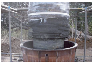
拡頭型H Y S C 杭（拡頭タイプSS）掘り起し試験
