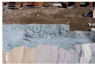
拡頭型H Y S C 杭（拡頭タイプSS）掘り起し試験
