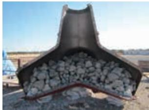
コンクリートからを使用して製造した消波ブロックの製作状況
