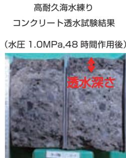
高耐久海水練りコンクリート透水試験結果 (水圧 1.0MPa, 48 時間作用後)
