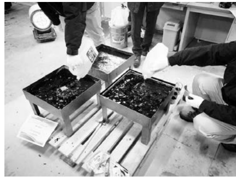
写真-1 透水フィルター性能確認試験
