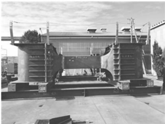
写真－1 清水港日の出岸壁（－12 m）改良工事における深梁本体
