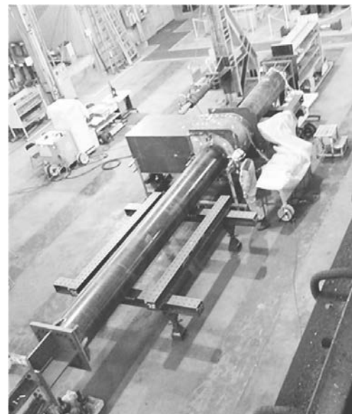
写真－5 面内曲げ試験の様子
