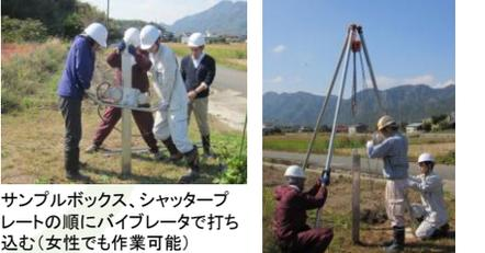
三脚とチェーンブロックを用いて地中から引き抜きサンブラーを引抜き、土を採取
