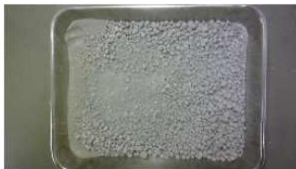
図-6 石炭灰造粒物（粒径5mm以下）
