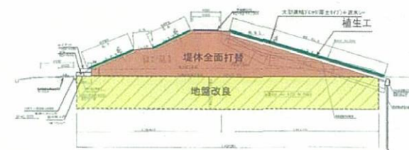
2003年宮城県北部の地震における 本復旧断面図
