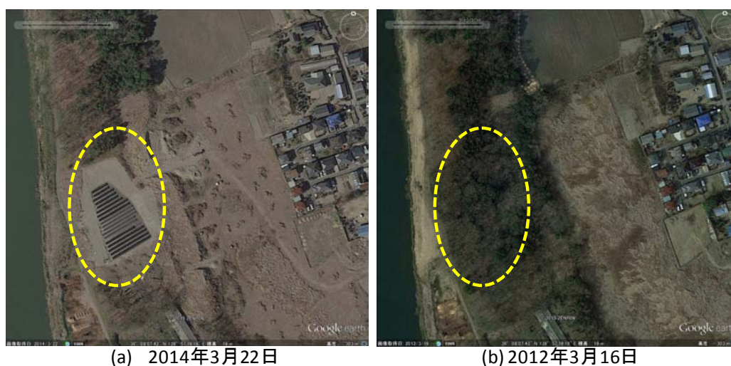
図 3-3 若宮戸地先における太陽光発電施設の建設に伴う地形の変化
