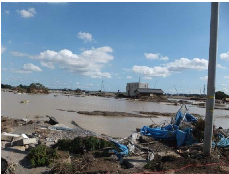
写真 5-1 流出しなかった家屋とそれに支えられている流出家屋
