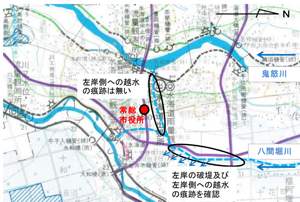
図 4-2 市役所付近の八間堀川の痕跡
