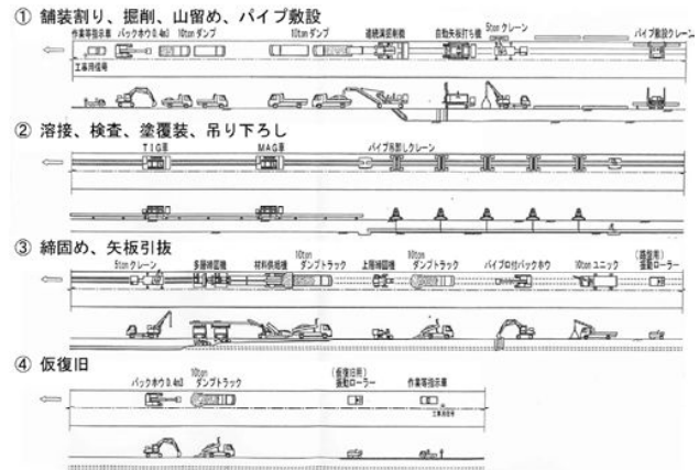
図 6-17 QPL 工法の建機帯列図
