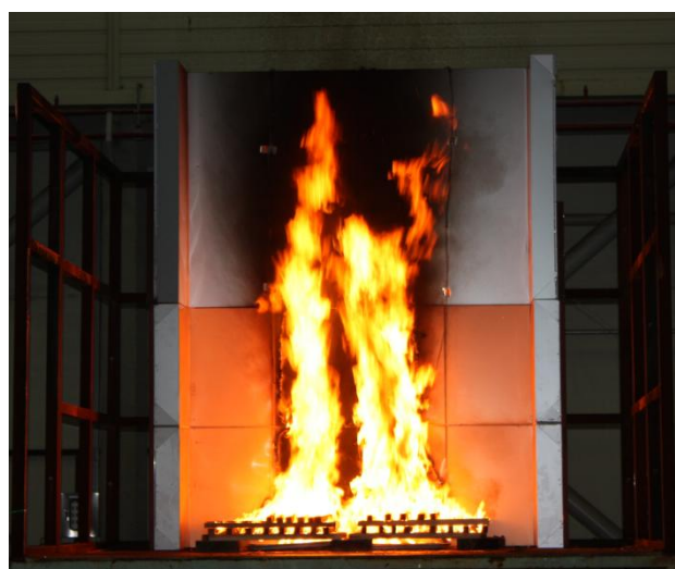
〈図 5〉 外装材の垂直伝播に関する模擬実験
