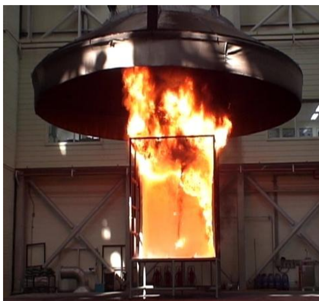
〈図 3〉 ウレタンフォーム実物火災実験
