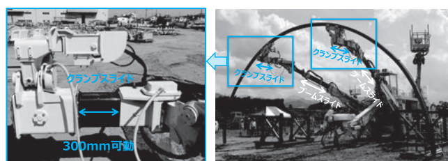
写真-7 クランプ部のスライド機構
